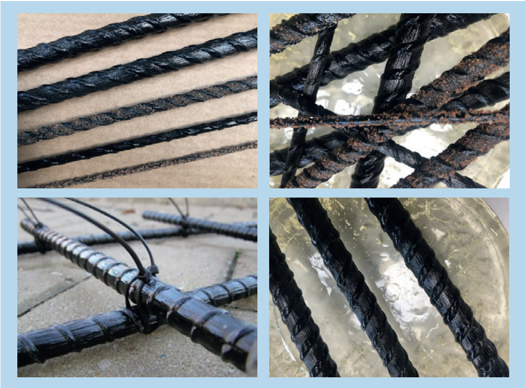
Rys. 2. Pręty bazaltowe wykonane przez SKN Nucleus AGH.
