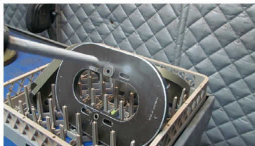
Rys. 3. Przedstawia element poddany czyszczeniu suchym lodem. Przed zastosowaniem tej metody i po.
