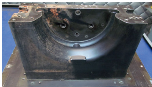
Rys. 4. Kompozytowa forma poddana czyszczeniu.
