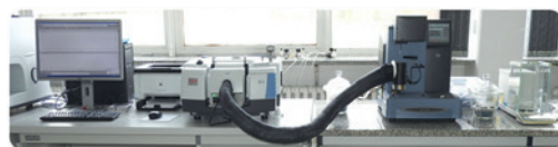
Rys. 1. Zestaw do analizy gazów wydzielanych TGA-FTIR.
