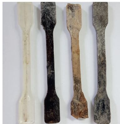
Rys. 5 Próbkki materiału po 48 godzinach w komorze starzeniowej
